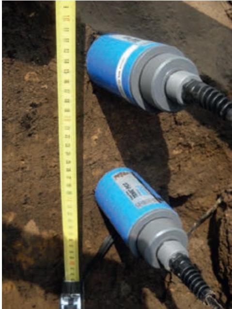
Figuur 20. Twee Trime PICO 64 sensoren in verticaal profiel bij pilot teler (JM).
