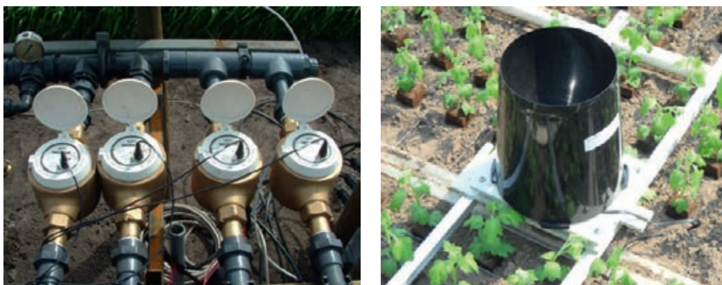
Figuur 9. Regenmeter (links) van: DAVIS, Rain Collector II, 7852 (zie manual), elektronische watermeters (rechts) een voorbeeld.
