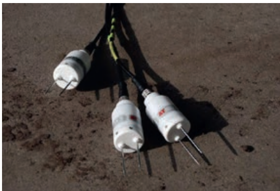
Figuur 26. De SM300 bodemvochtgehalte sensor van DeltaT-Devices Ltd (UK) zoals gebruikt in dit project.
