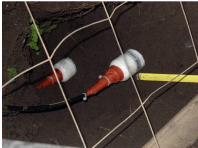
Figuur 29. Plaatsing van sensoren op twee diepten in het verticale profiel (SM300).
