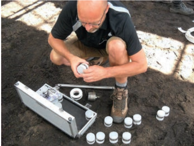
Figuur 28. Grondbemonstering voor bodemtype kalibratie van vochtsensoren.
