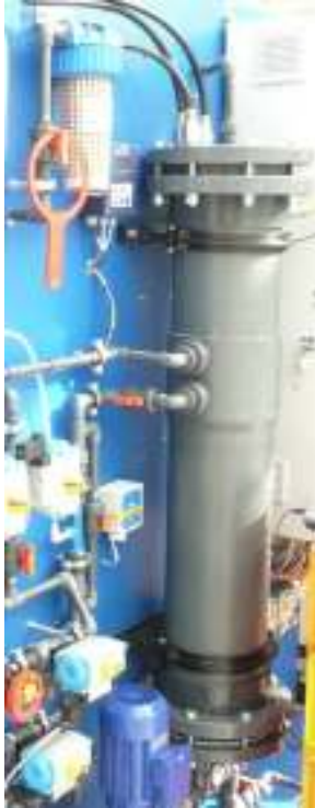
Figuur 5. Onderzoeksinstallatie voor ontsmetten en zuiveren met een ozoninstallatie.
