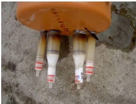
Figuur 4.16: Flow-Caps na de installatieperiode van 30 november tot 11 januari; geen verstopping, wel wat grassprietjes (links), goed verkleurde adsorptiereservoirs en ruime hoeveelheden zout verdwenen in de SorbiCells (rechts).
