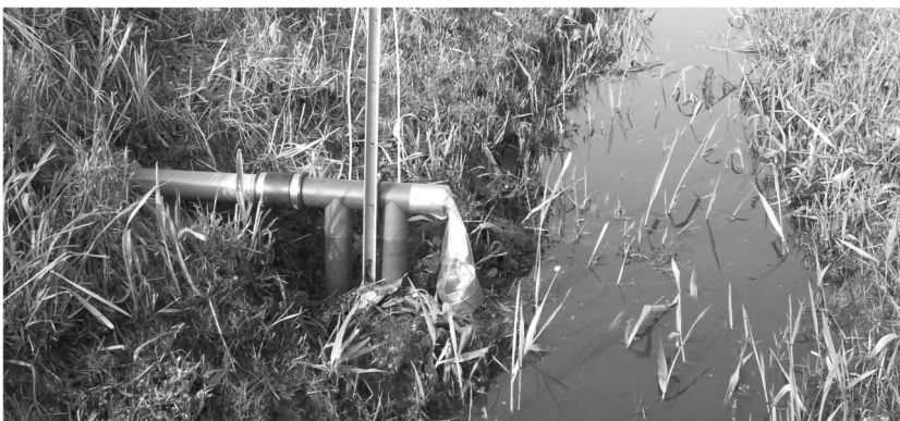
Figuur 2: Installatie van SorbiCells in stromend (links) en stilstaand of langzaam stromend oppervlaktewater (rechts).
