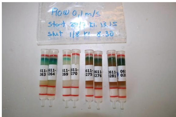
Figuur 3.5: Foto van patronen na 3 dagen plaatsing in doorstroombad bij een stroomsnelheid van 0,1 m/s, experiment P097. De linker 4 SorbiCells zijn NiP- en de rechter 4 CAN-SorbiCells. Van deze 4 hebben de linker 2 een 60–100 \mu m en de rechter 2 een 100-160 glasfilter.
