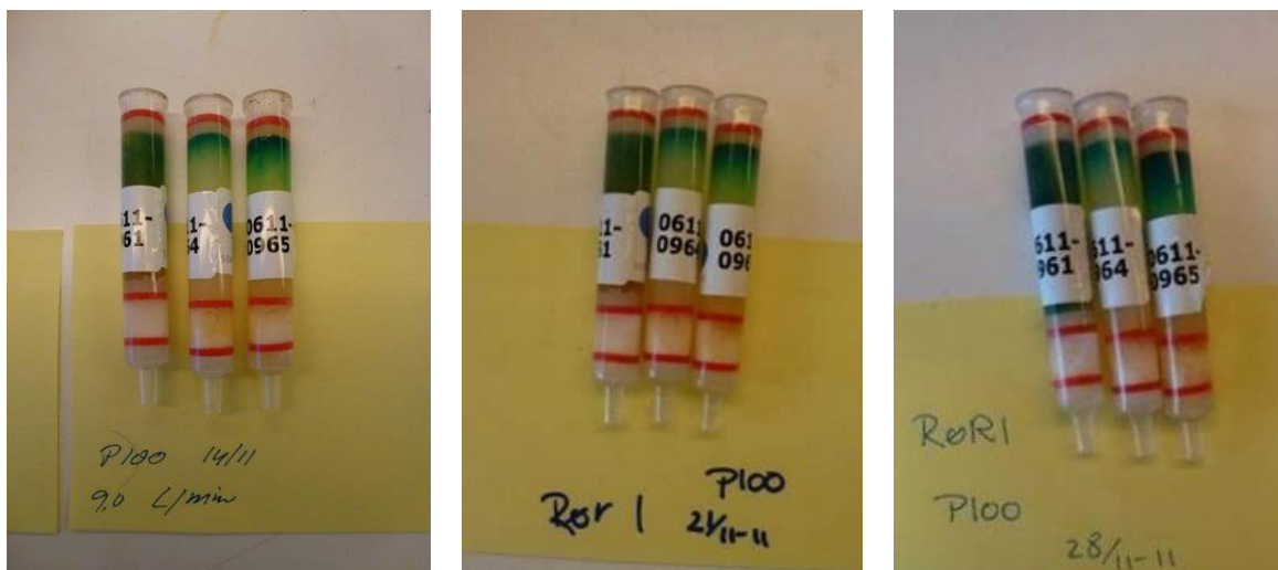
Figuur 3.9: Fotoserie na 1,2 en 3 weken doorstroming (van links naar rechts) van patronen bij plaatsing in drains bij een stroomsnelheid van 10 cm/s, P100
