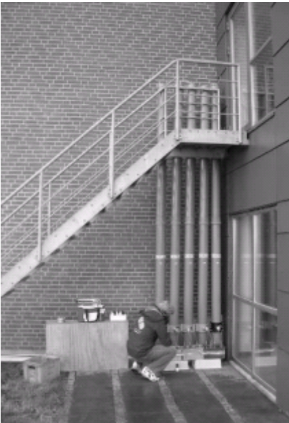
Figuur 2.3: Testen van de waterdruk-doorstroomsnelheid relatie van de SorbiCells.
