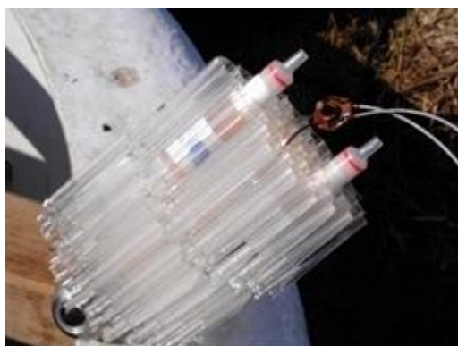
Figuur 4.10 SorbiCells in spacer zoals geïnstalleerd op locatie Rusthoeve.
