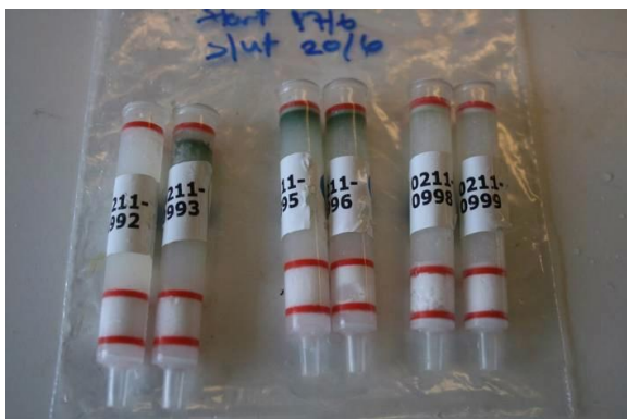
Figuur 3.3: Foto van patronen na 3 dagen plaatsing in doorstroombad bij een stroomsnelheid van 0,1 m/s, experiment P093. De linker 2 SorbiCells hebben fritted glasfilters, de middelste 2 hebben glasvezelfilters aan de bovenzijde en de rechter 2 glasvezelfilters aan twee zijden.
