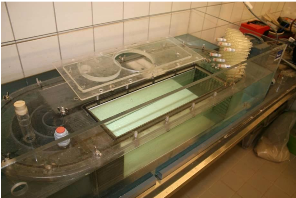
Figuur 3.2: Stroombad in het Sorbisense laboratorium voor het testen van in-stream SorbiCells.
