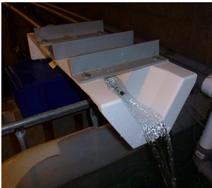
Figuur 3.10: SorbiCell geïnstalleerd in een trapezöide-vormige meetgoot (Pastifab, USA)
