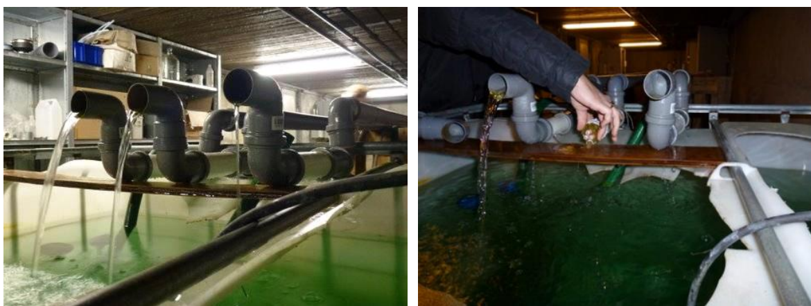
Figuur 3.6: Laboratorium testopstellingen met in-stream installatie in u-vormige opzetstukken
