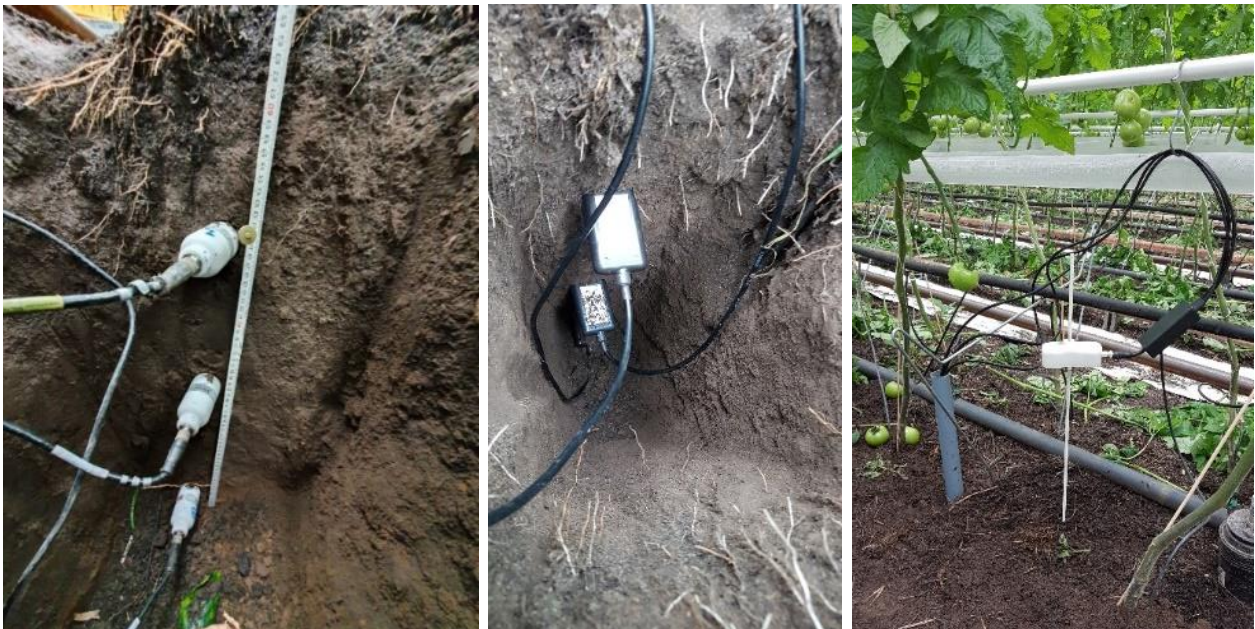
Figuur 3.8 Meetopstelling met de set bodemvochtsensoren op drie dieptes van DeltaT Devices SM300 bij bedrijf A (links), van Quantified Triple Poseidon (midden) en Quantified Firefly voor datatransmissie (rechts) bij bedrijf B.
