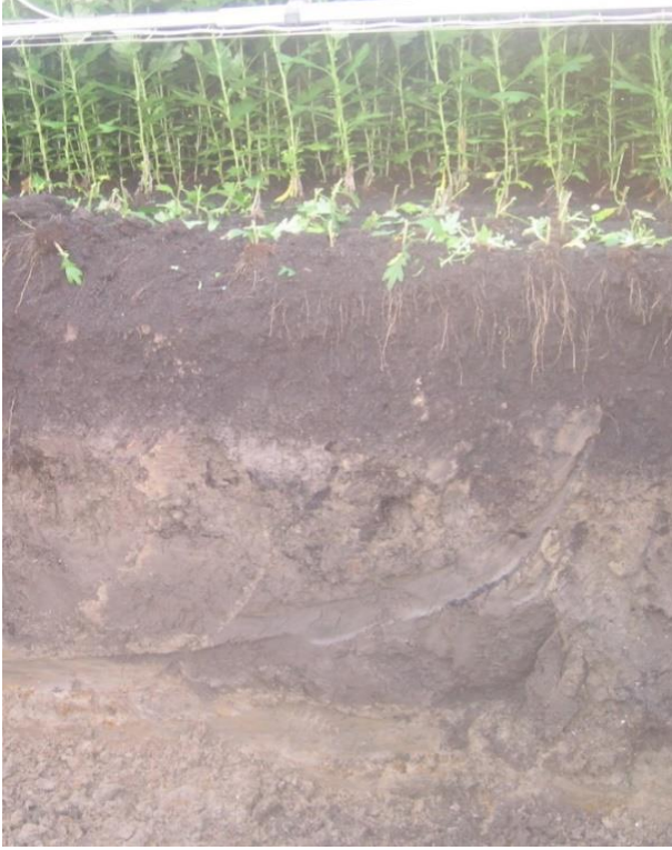
Figuur 1.1 De virtuele lysimeter beoogt een versimpelde weergave te geven van de opbouw van een bodem in een kas, waarvoor rekening wordt gehouden met de textuur (zand, klei, silt), de organische stofgehalten en de dichtheid per laag van 30 cm.
