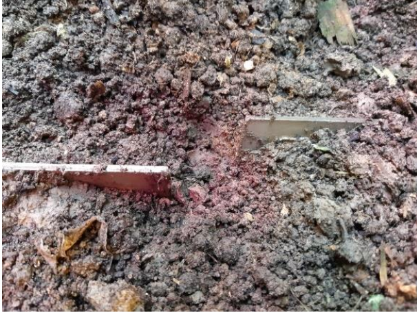
Figuur 4.2 Beeld van de beschadigde bovenrand van de Fysieke lysimeter door grondbewerking (bedrijf D).
