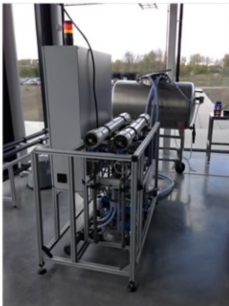
FIGUUR 2-1 4040 TESTBANK MET 2 HORIZONTALE MEMBRANEN
