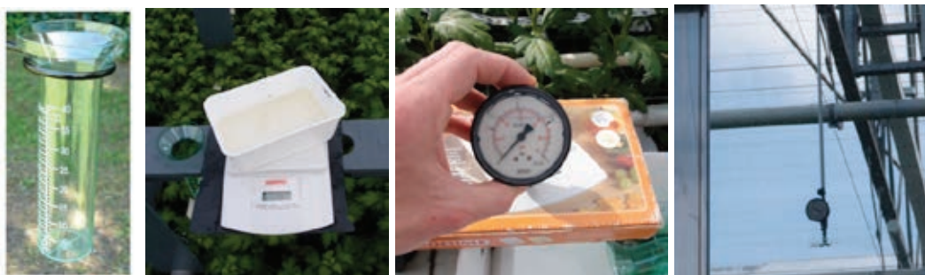
Figuur 9. vlnr gebruikte regenmeter in meetopstelling, weegschaal voor het meten van bakgewicht, druk meter, druk meter gemonteerd voor de sproeier om de druk op de sproeier te kunnen aflezen.
