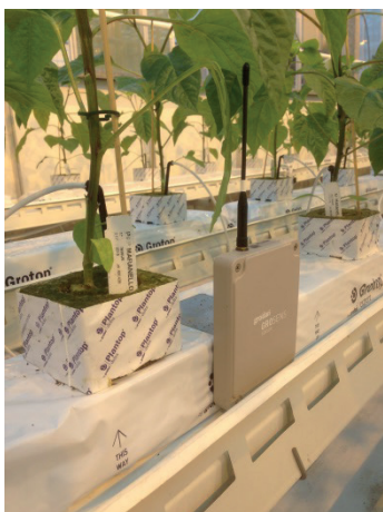
Figuur 8 Grosens sensor geplaatst in een steenwol substraatmat voor het bepalen van geleidbaarheid, watergehalte en temperatuur van de mat.
