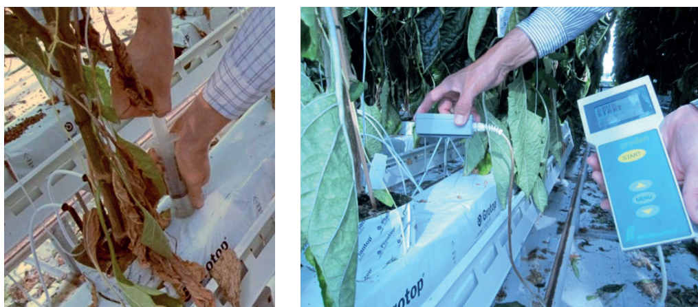
Figuur 10 Monstername van water uit de mat (links) en meting van vochtgehalte, EC en temperatuur (rechts).
